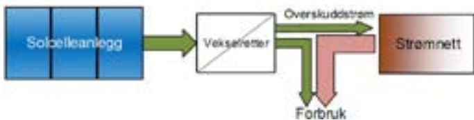
Figur 1: SOLSTRØM FLYTER FRA SOLPANELENE INN I INVERTEREN. OVERSKUDD FLYTER UT PÅ NETTET, MENS RESTEN AV PRODUKSJONEN FORBRUKES BAK STRØMMÅLEREN.
